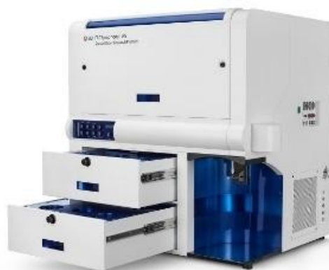
Obr. 3: Průtokový cytometr FACS Symphony (v těch šuplíčcích jsou filtry pro lasery), cena přes 30 milionů. – https://www.bdbiosciences.com/assets/images/biosciences/thumbnails/FACSSymphony-A5-opened.jpg
